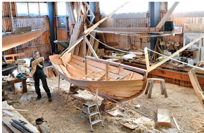
Det här är den första båt Madeleine Harms bygger helt på egen hand, en fem meter lång båt inspirerad av Kökarsjullar. Den ska gå att både segla och ro.
